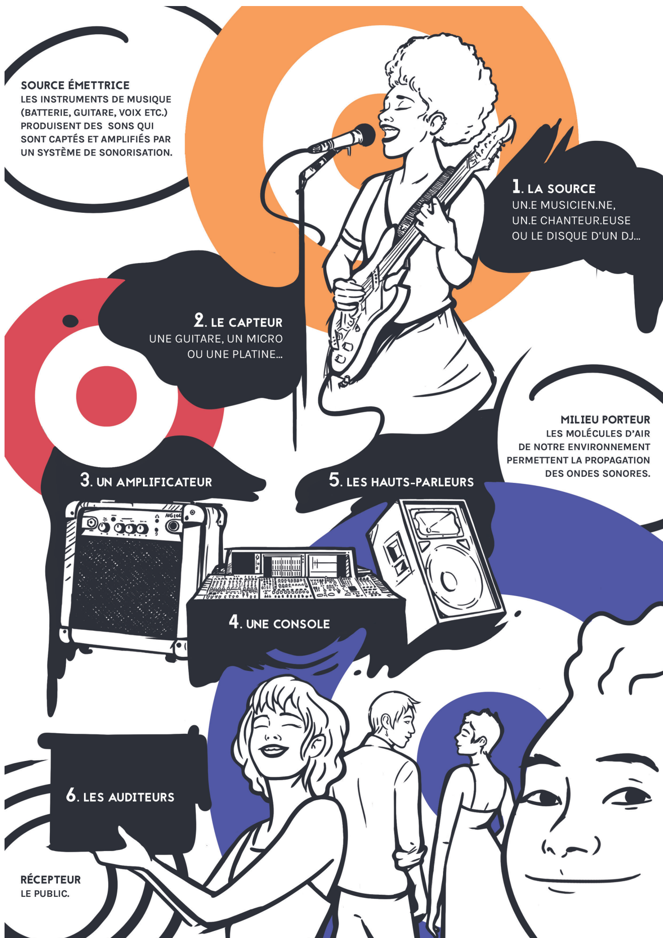
Schéma illustrant l'amplification et la diffusion du son
